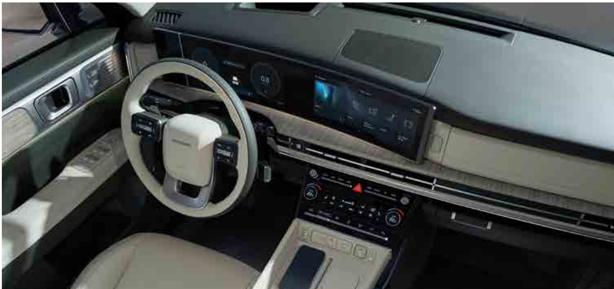
Панорамалық қиғаш дисплей: диагоналы 12,3 дюйм аспаптар панелі және диагоналы 12,3 дюйм ақпараттық-ойын-сауық жүйесінің орталық дисплейі
