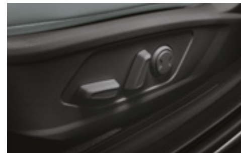
Водительское сидение с электроприводом регулировки в 8 направлениях и поясничной опорой
